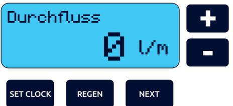
Der Bildschirm zeigt Ihnen die Strömungsgeschwindigkeit/den Wasserdurchfluss in Litern pro Minute an.
