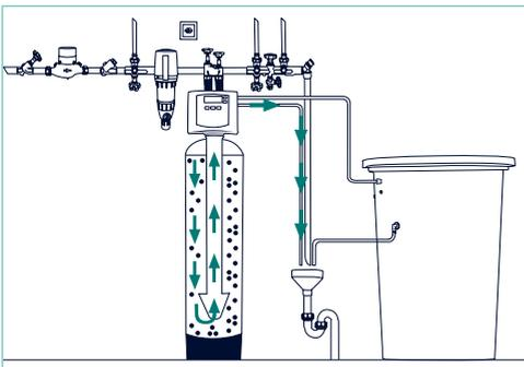
Um sicherzustellen, dass alles Salz entfernt wurde, macht die Anlage ein Schnellspülen mit grosser Fließgeschwindigkeit.
