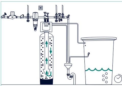
In diesem Schritt wird die Sole aufgelöst. Dies kann bis zu 180 Minuten dauern. Die Anlage funktioniert unterdessen normal und liefert weiches Wasser.
