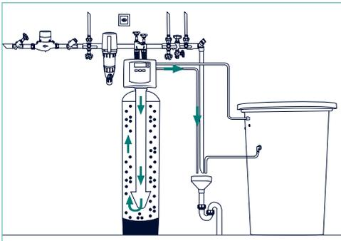
Die Anlage wird das Harzbett nun rückspülen, um das restliche Salz aus der Anlage zu entfernen.
