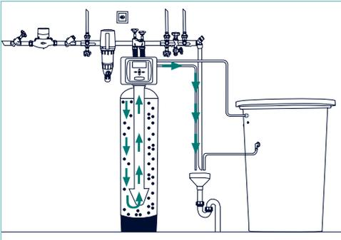
Um sicherzustellen, dass alles Salz entfernt wurde, macht die Anlage noch ein Schnellspülen mit grosser Fließgeschwindigkeit.
