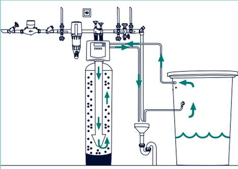
Das Harzbett wird nun mit der aufgelösten Sole von unten nach oben besalzen, um die Austauschkapazität des Harzes wieder herzustellen.
